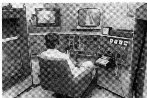
Obr. 2 Pult instruktora u pilotního trenažéru TL-39
