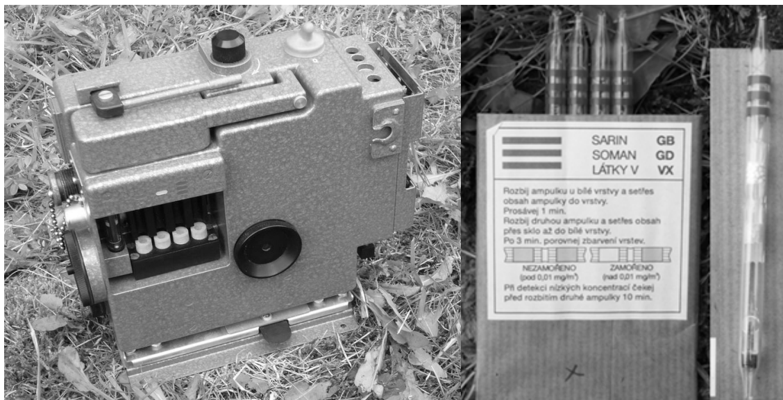
Obr. 1: Fotografie Chemického průkazníku 71. V levé části je balení trubiček pro stanovení nervově paralytických látek a dále detail vlastní trubičky.
