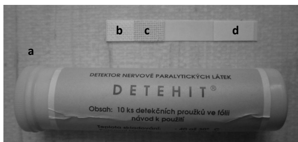
Obr. 2: Průkazník nervově paralytických látek Detehit. Význam symbolů: a – tuba obsahující balené průkazníky a návod, b – detekční tkanina průkazníku s vázanou AChE, c – žlutý etalon, d – indikační papír
